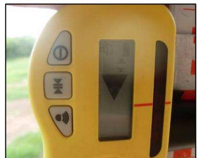
Photo 6 : flèche indiquant la direction du rayon laser
